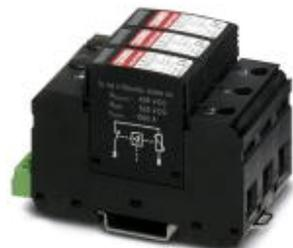
Blitzstrom- / Überspannungsableiter für 2-polige isolierte Gleichspannungssysteme 1000 V DC, für Tragschienenmontage, 3-poliges Basiselement mit Fernmeldekontakt, drei steckbare temperaturüberwachte Schutzelemente, Statusmeldung an jedem Stecker.
